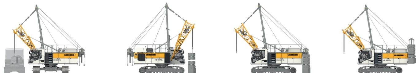
Scarico, assemblaggio e montaggio della zavorra posteriore
