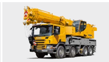
Grúas telescópicas sobre camión LTF
