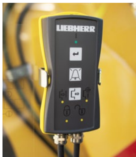
Unité de commande pour le deuxième adaptateur de changement rapide
