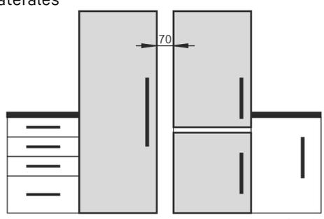
Si cette distance n'est pas respectée, de la condensation se formera sur les parois latérales des appareils.
