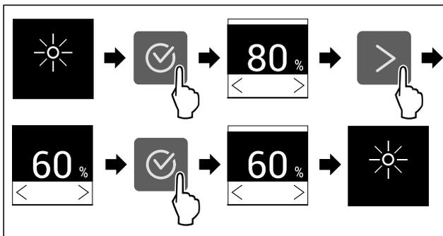
Fig. 48 Beispielhafte Darstellung: Von 80 % zu 60 % wechseln.
