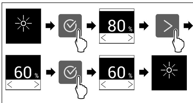
Fig. 40 Beispielhafte Darstellung: Von 80 % zu 60 % wechseln.
