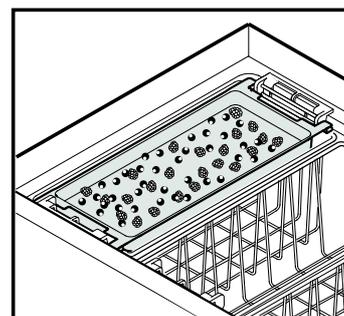
Die Tiefkühlablage kann entweder an den Korb gehängt oder in den Innenbehälter geschoben und als Trennwand genutzt werden.
