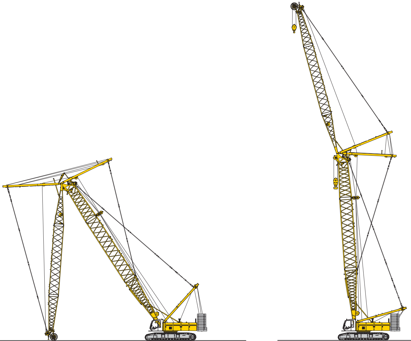
Подъем основной стрелы и управляемого удлинителя стрелы
