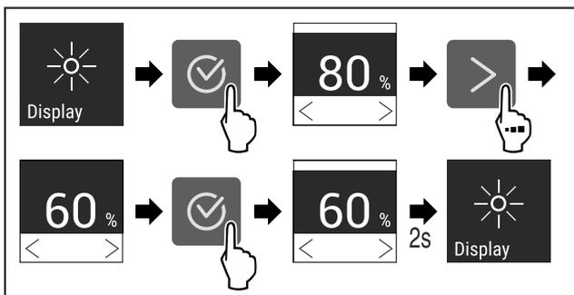
Fig. 128 Représentation à titre d'exemple : Passer de 80 à 60 %.
