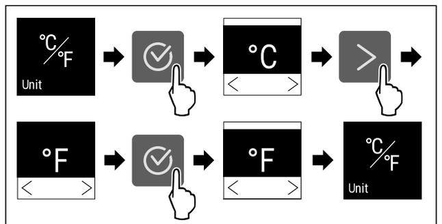
Fig. 126 Représentation à titre d'exemple : Passer du degré Celsius au degré Fahrenheit.
