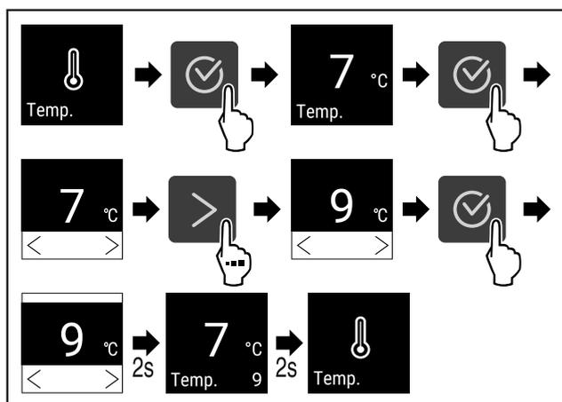
Fig. 95 Changement de température de 7 °C à 9 °C
