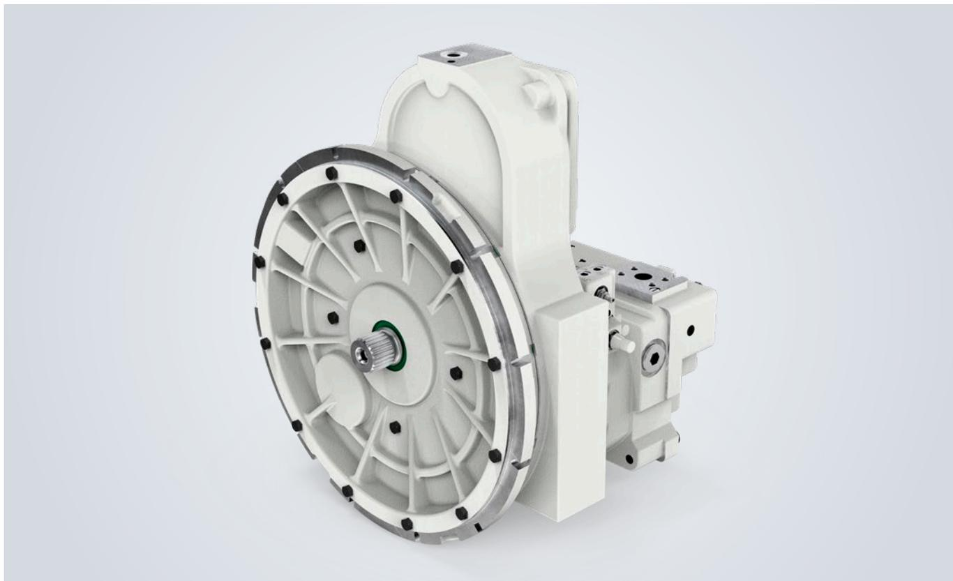
Аксиально-поршневые насосы с наклонным диском серии DPVP фирмы Liebherr спроектированы как параллельный насос для открытого контура. Регулируемые насосы выпускаются с номинальными размерами от 108 до 165 см<sup>3</sup>. Номинальное давление узлов составляет 400 бар, а наивысшее давление составляет 450 бар, абсолютное.
