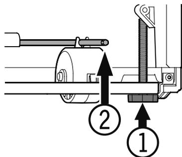
2. Ajuster la hauteur à l'arrière de l'appareil à l'aide des barres d'ajustage (2).
