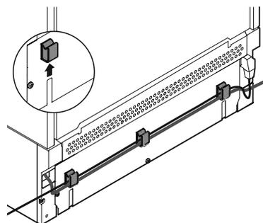
Monter les supports de câble à l'arrière de l'appareil. Placer le cordon d'alimentation/la conduite d'eau dans les supports de câble.
