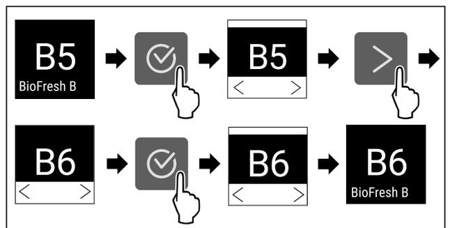
Fig. 22 Beispielhafte Darstellung: Von B5 zu B6 wechseln.
