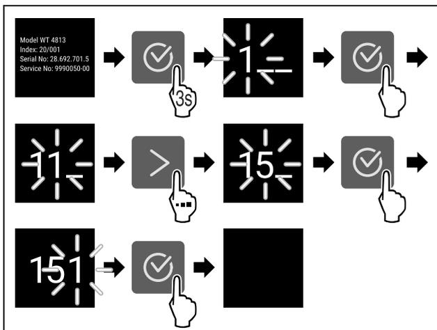
Fig. 4 Beispielhafte Darstellung, Zugang mit Zahlencode 151
