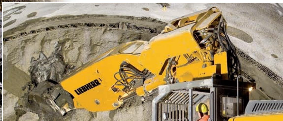
Protection du balancier et des vérins hydrauliques
