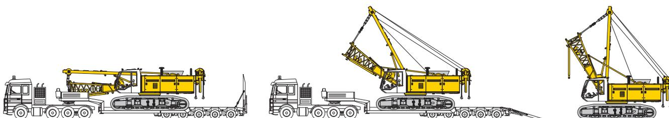
Разгрузка базовой машины (стандарт)
