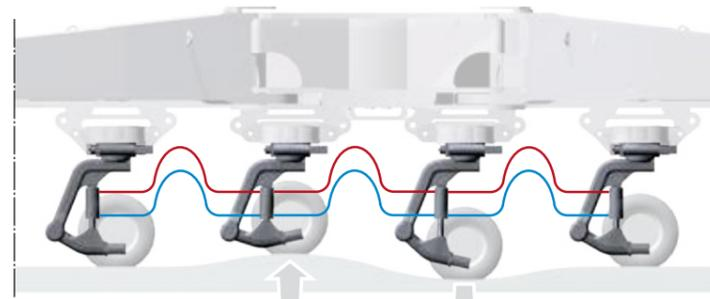
Ótima distribuição de pressão e adaptação dos jogos de rodas em qualquer tipo de superfície
