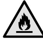
**WARNUNG:** Brandgefahrg / brennbare Materialien. Das Symbol befindet sich am Verdichter und kennzeichnet die Gefahrg vor feuergefährlichen Stoffen. Den Aufkleber nicht entfernen.
