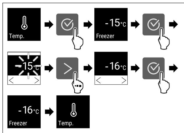
Fig. 63 Temperaturwechsel von -15°C auf -16°C
