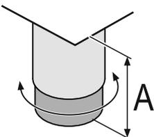
Fig. 10 Der Stellfuß ist von  $A = 150 \text{ mm}$  ( $6 \frac{5}{16} \text{ in}$ ) bis  $180 \text{ mm}$  ( $7 \frac{1}{16} \text{ in}$ ) verstellbar.\*
