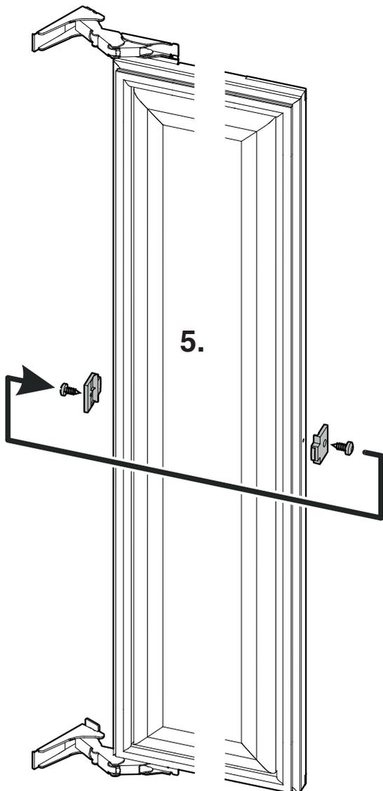
**6.** Destornillar las bisagras y las tapas protectoras y volver a atornillarlas cada vez en la posición diagonal opuesta.
