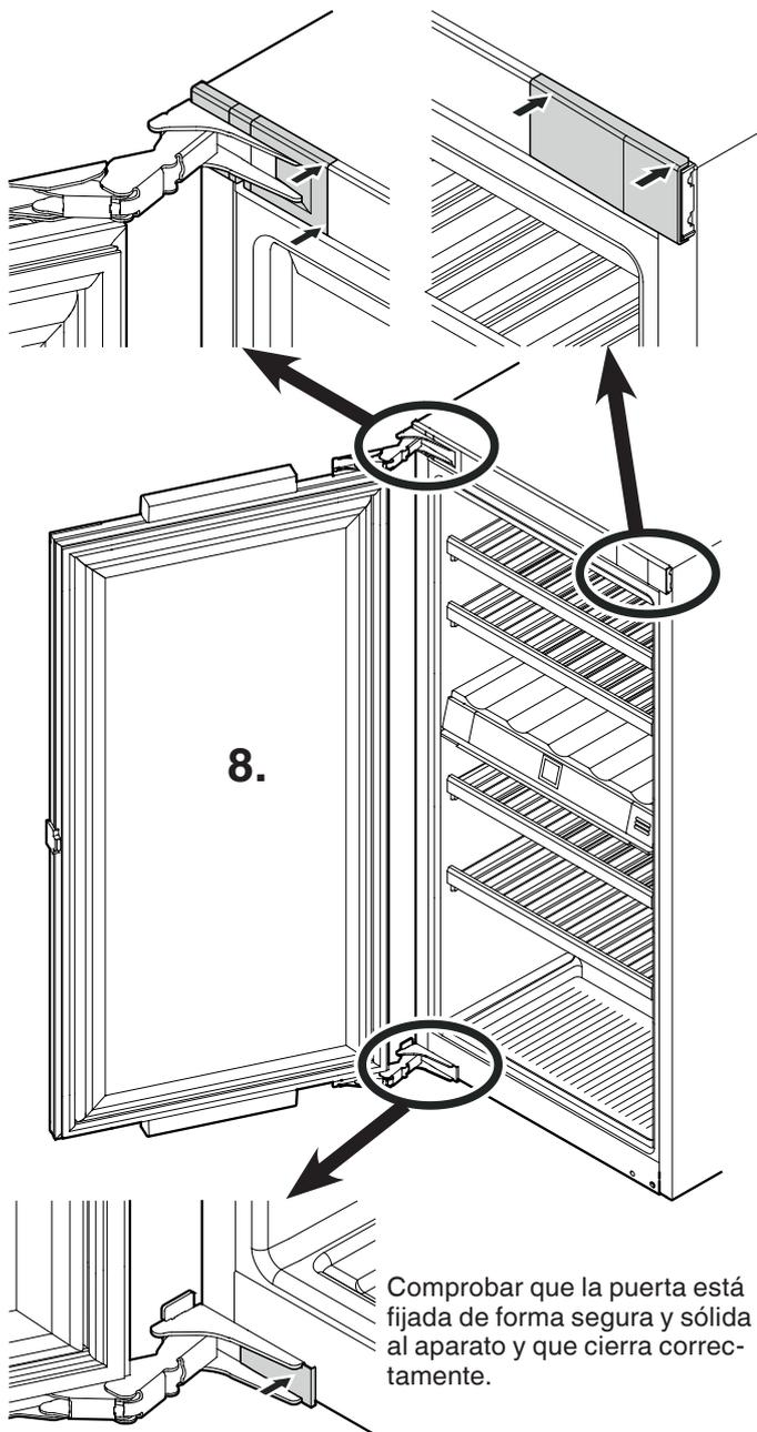
Comprobar que la puerta está fijada de forma segura y sólida al aparato y que cierra correctamente.
