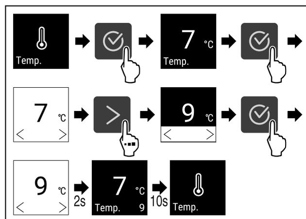
Fig. 35 Changement de température de 7 °C à 9 °C
