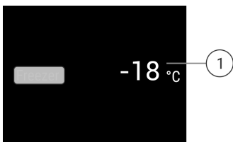
Fig. 7 L'indicatore di stato mostra la temperatura reale.
