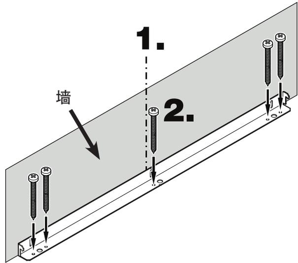
如果冰箱安装在深度超过 620 mm 的家具间，则冰箱将无法接触到防倾翻支架。
