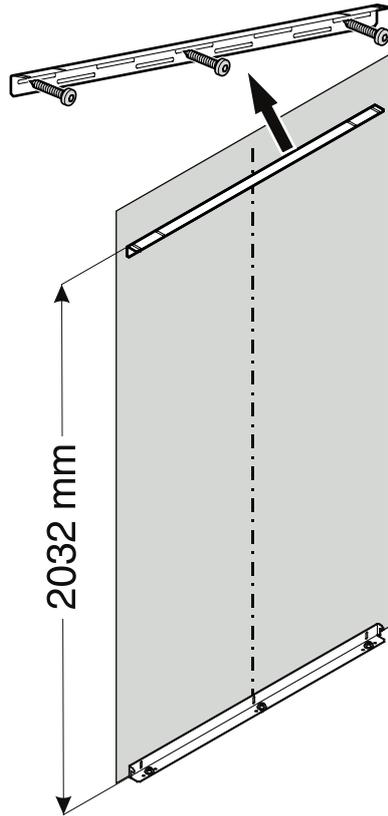
2. 将两个连接支架插入到冰箱的运输卡口内。
