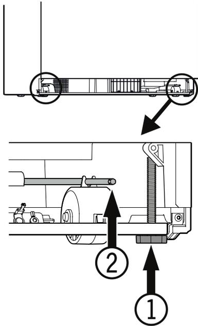
2. 顺时针旋转调节杆 (2)至压缩机安装板与防倾翻支架接触为止。
