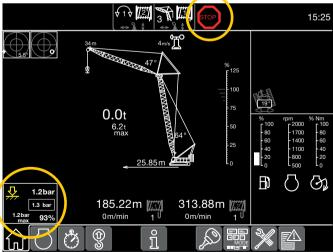
Nähert sich der Bodendruck dem eingestellten Wert, wird eine akustische und optische Warnung ausgegeben.
