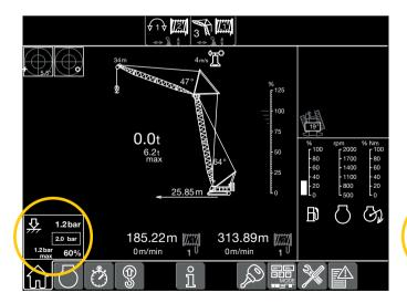
Der aktuelle Bodendruck wird in Echtzeit auf dem Monitor in der Fahrerkabine angezeigt.
