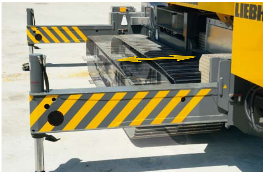
Praxisorientiert: Anpassungsfähige Standbasis beim Versetzen auf der Baustelle durch verschiebbare Raupen.
