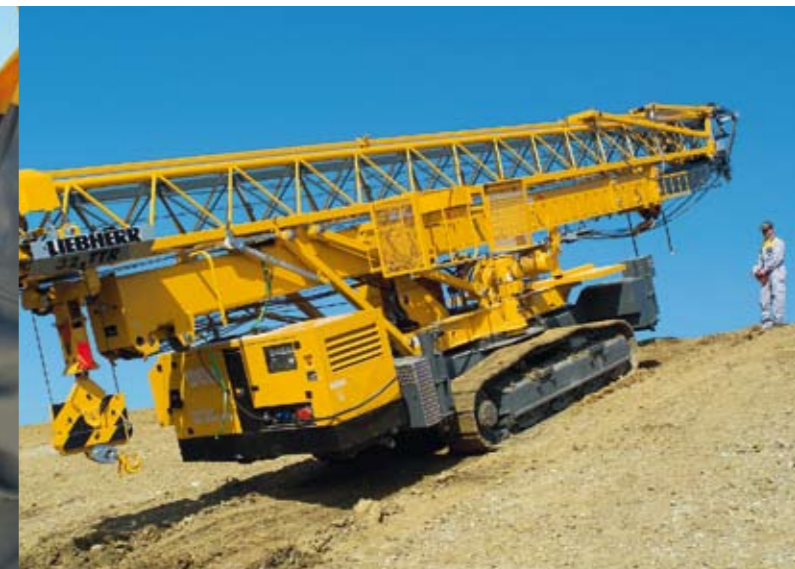
Steile Sache: Verfahren der Raupenkrane bis Steigungen von 30%.
