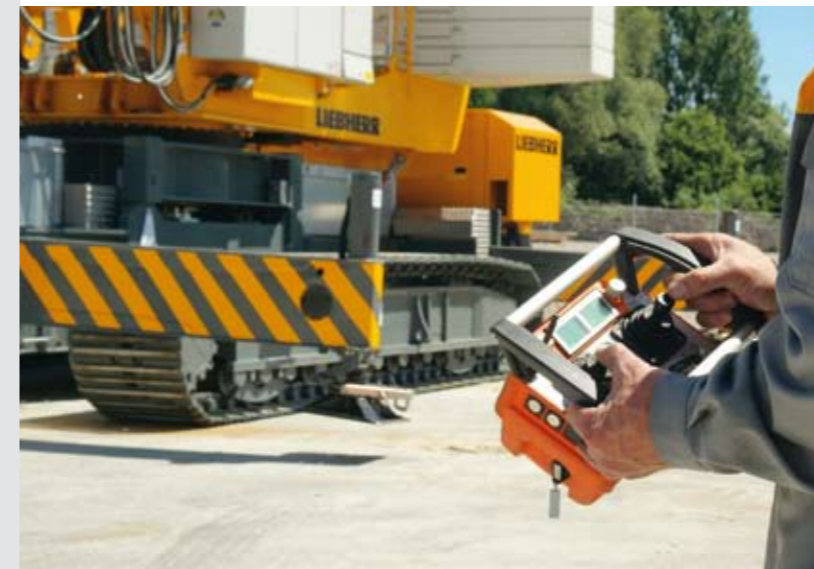
Drahtlos bewegen: Einfache Bedienung mittels Funkfernsteuerung.
