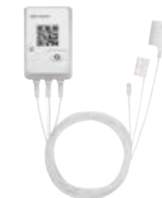
Záznamník dat, 3kanálový (6145365) Tříkanálový záznamník dat je kromě standardního teplotního čidla vybaven také dalším teplotním čidlem, pomocí kterého lze dodatečně sledovat teplotu citlivých výrobků, a také čidlem dveřního kontaktu.
