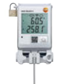
Záznamník dat, ULT (6145367) Pro bezpečné skladování při extrémních teplotách je tento datový záznamník vybaven speciálním teplotním čidlem pro teplotní rozsahy až do -200 °C, které pokrývá všechny situace chlazení jedním řešením.
