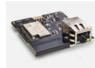
SmartModule (6145269) SmartModule propojuje spotřebiče Liebherr řady Performance do sítě s funkcí SmartMonitoring nebo se stávajícími monitorovacími systémy. Malá jednotka s integrovaným rozhraním LAN/WiFi je po montáži na zadní stranu spotřebiče ihned připravená k provozu.
