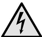
El símbolo se encuentra en la parte trasera de la carcasa en la zona del relé de alarma e indica el siguiente peligro: **¡descarga eléctrica!** En un electrodoméstico desconectado de la red puede haber todavía tensión residual. No retirar la etiqueta.
