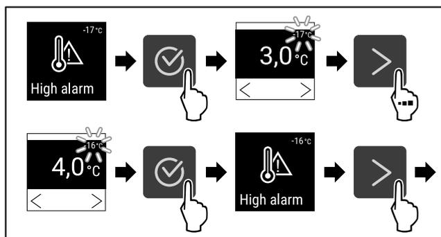
Fig. 127 Ejemplo de ajuste del límite inferior de temperatura basado en una temperatura de electrodoméstico ajustada de -20 °C.
