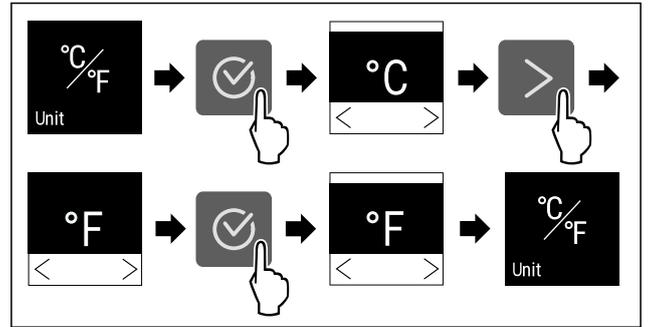
Fig. 89 Representación a modo de ejemplo: Cambiar de grados Celsius a Fahrenheit.
