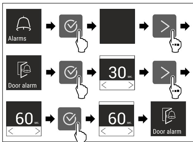
Fig. 136 Representación a modo de ejemplo: Cambiar alarma de puerta de 30 segundos a 60 segundos.
