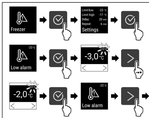
Fig. 126 Ejemplo de ajuste del límite inferior de temperatura basado en una temperatura de electrodoméstico ajustada de -20 °C.
