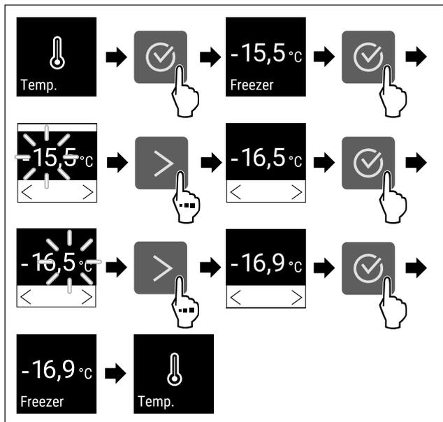
Fig. 70 Cambio de temperatura de -15,5 °C a -16,9 °C
