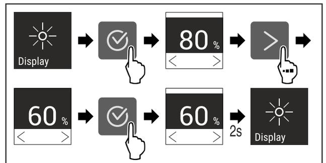
Fig. 91 Representación a modo de ejemplo: Cambiar de 80 % a 60 %.
