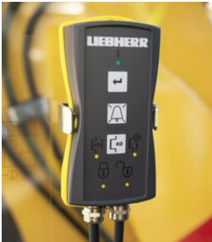
Bedieneinheit für zweiten Schnellwechselsadapter
