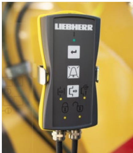
Bedieneinheit für zweiten Schnellwechselsadapter
