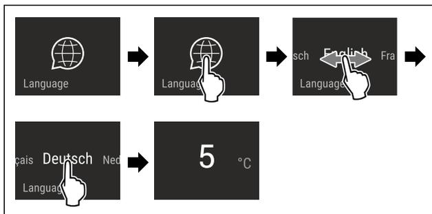
Fig. 32 Beispielhafte Darstellung je nach Sprache und Temperatur
