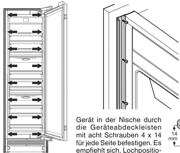
Gerät in der Nische durch die Geräteabdeckleisten mit acht Schrauben 4 x 14 für jede Seite befestigen. Es empfiehlt sich, Lochpositionen in der Leiste anzuzeichnen und vorzubohren.
