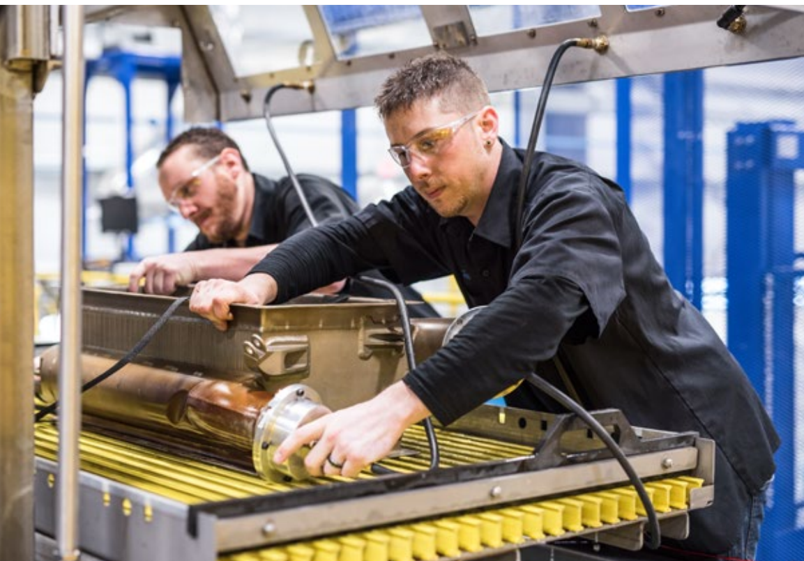
Nach der Reinigung wird der Wärmetauscher getestet.
