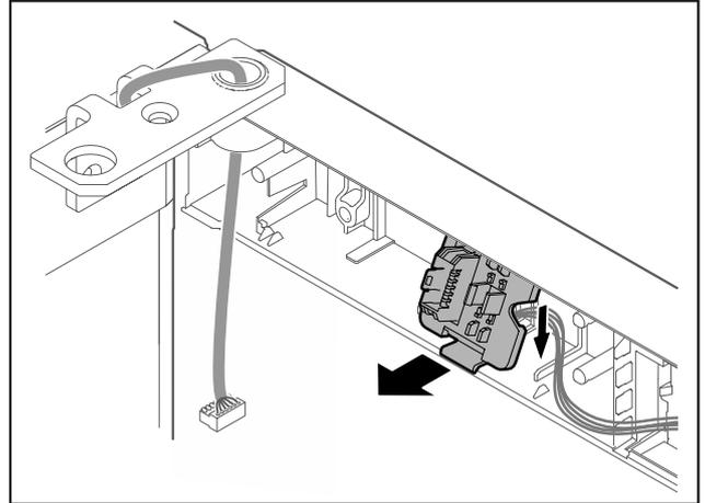
Fig. 22 La position de montage du support de connecteur peut être tournée de 180°.
