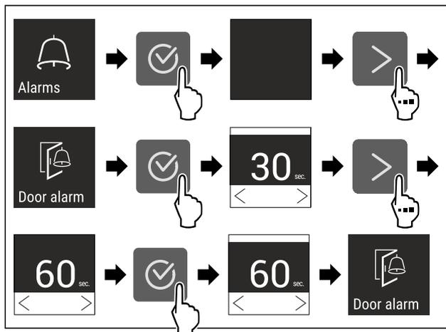
Fig. 134 Représentation à titre d'exemple : modification de l'alarme de porte de 30 secondes à 60 secondes.
