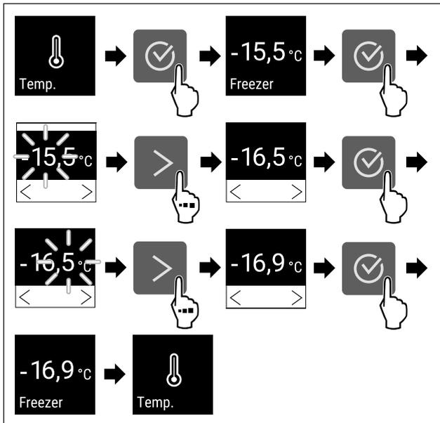
Fig. 68 Changement de température de -15,5 °C à -16,9 °C
