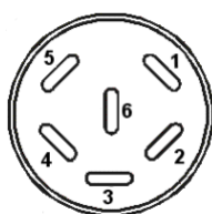
Obr. 20: Obsazení pinů zdířky (10) pro volbu analogového výstupu
