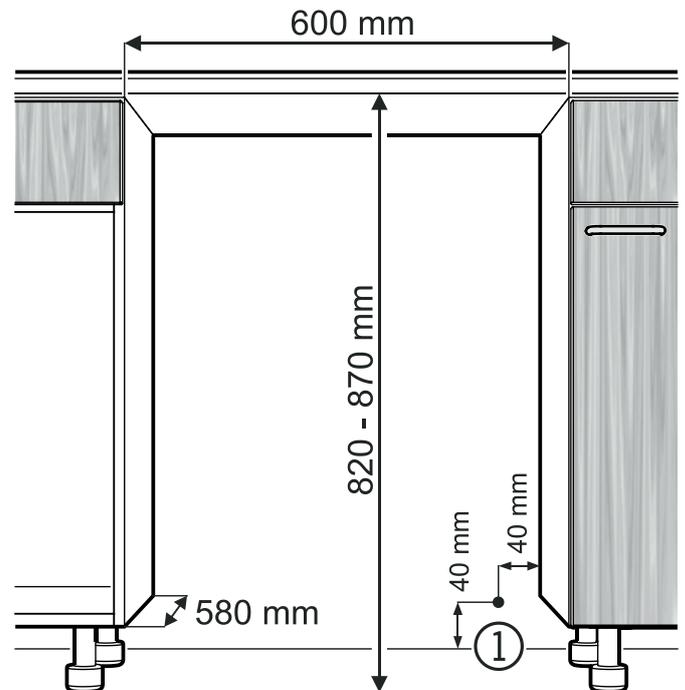
(1) In diesem Bereich kommt die Netzzuleitung aus der Rückseite des Gerätes.
