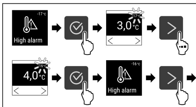
Fig. 134 Esempio di regolazione del limite superiore di temperatura, sulla base della temperatura impostata dell'apparecchio di -20 °C.
