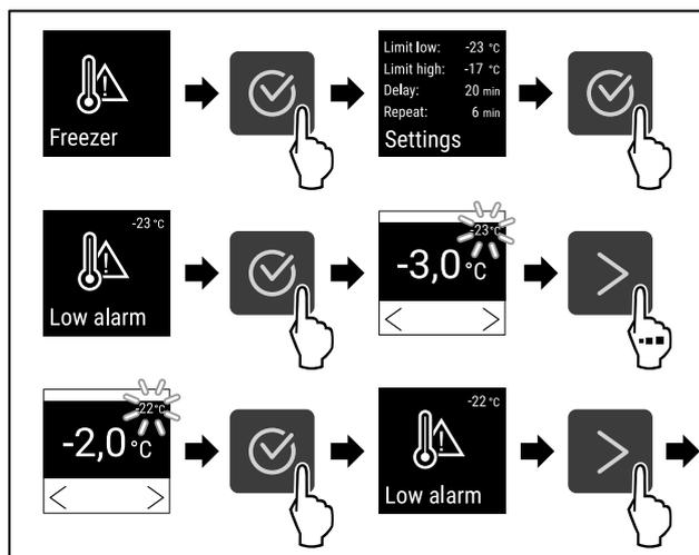
Fig. 133 Esempio di regolazione del limite inferiore di temperatura, sulla base della temperatura impostata dell'apparecchio di -20 °C.
