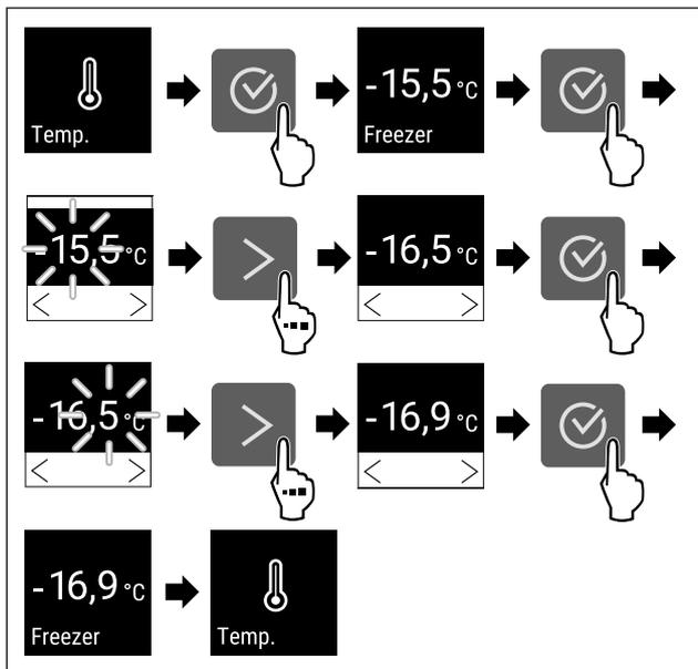
Fig. 70 Variazione di temperatura da -15,5 °C a -16,9 °C
