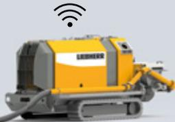
Bei der Herstellung von Ortbetonpfählen versorgen Raupenbetonpumpen das Bohrgerät mit Frischbeton.
