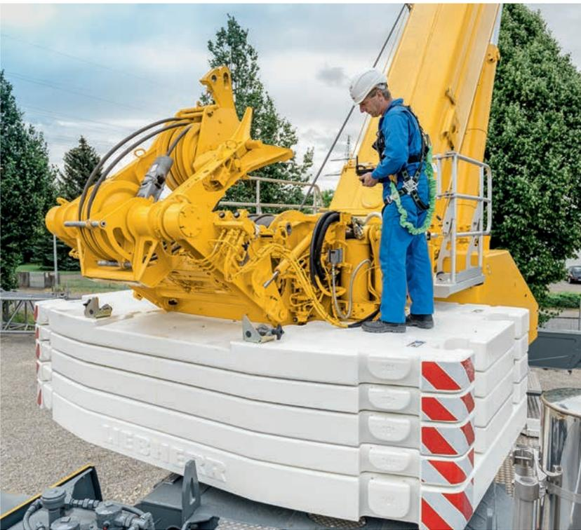
Montage autonome du treuil 2 sur la LTM 1300-6.2
