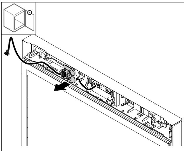
Fig. 28 Vous pouvez tourner le support de connecteur à 180° pour le monter dans la position inverse.
