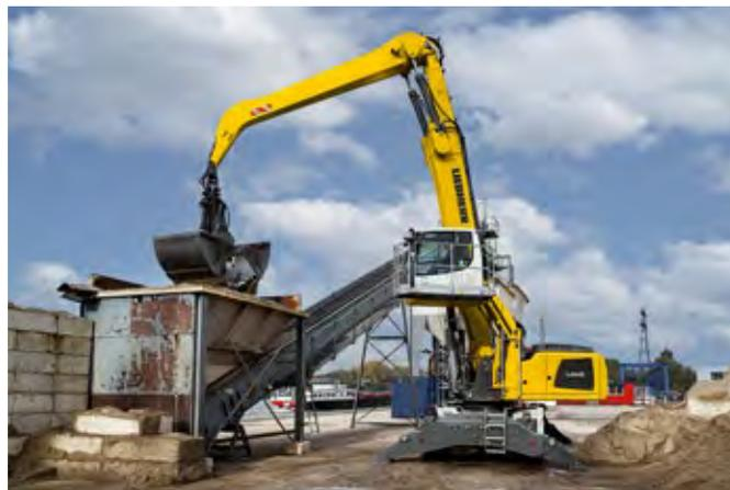
Gestione di un impianto di betonaggio con LH 40 M Industry Litronic
