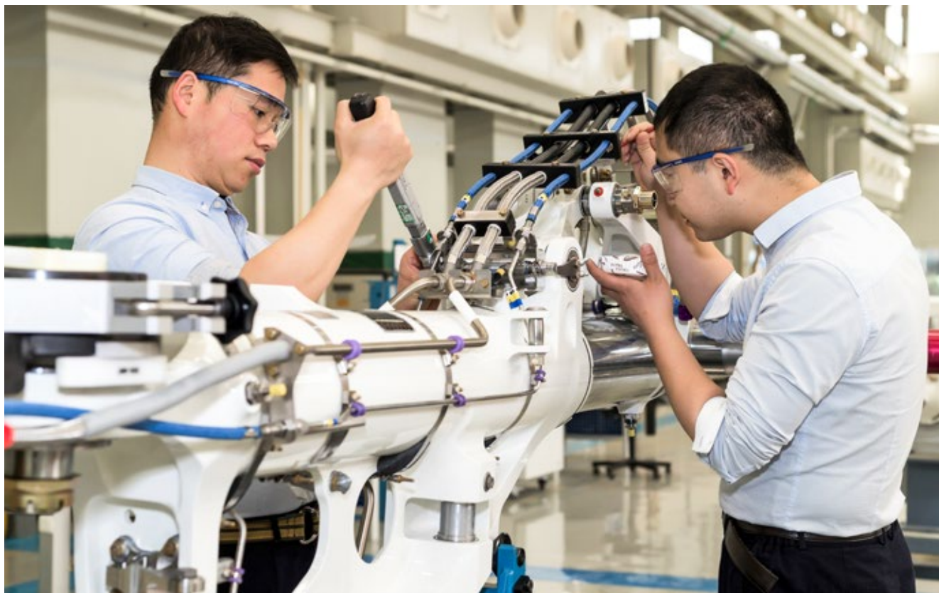
Travaux de montage d'un train d'atterrissage à Changsha (Chine)
