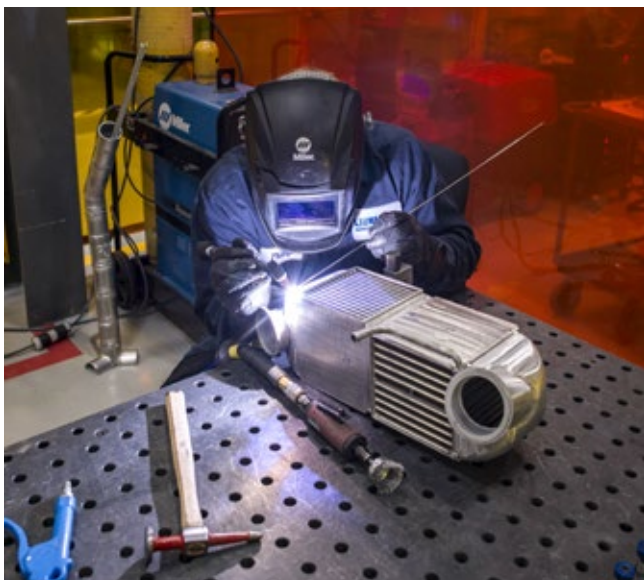
Un soudeur à Saline (MI/États-Unis), réalise un cordon de soudure sur un échangeur thermique
