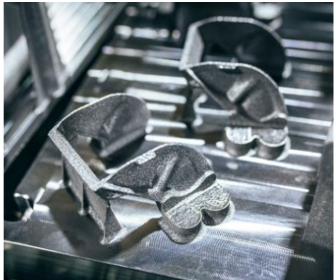
Deux supports de capteurs de proximité pour le train d'atterrissage avant de l'A350 après l'impression
