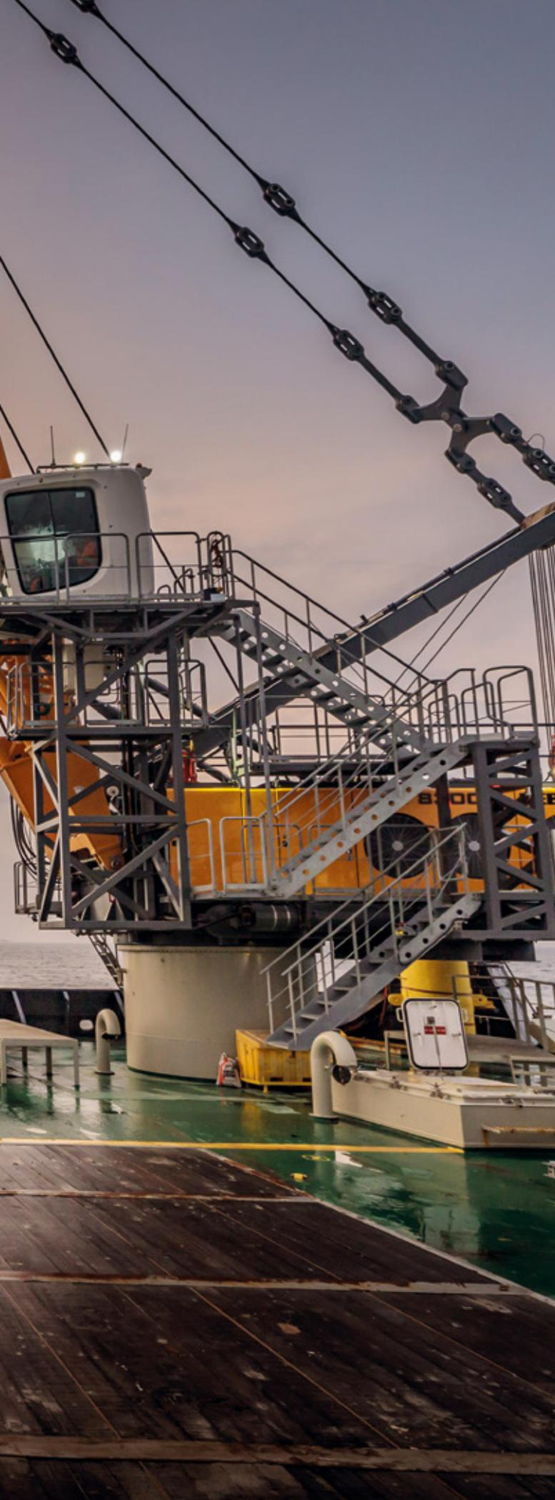
Mit einem Einsatzgewicht von 350 Tonnen zählt der HS 8300.2 von Liebherr zu den größten Hydroseilbaggern. Er kann mit verschiedenen großvolumigen Schürfkübeln und Greifern ausgestattet werden.
