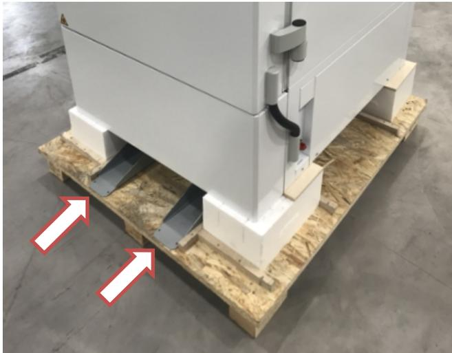
Gerät nach Entfernen des Kartons. Zwei Entladerampen (Pfeile) sind auf der Palette festgeschraubt.
