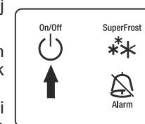
**Isključivanje uređaja:** Držite pritisnutim gumb **ON/OFF (uključivanje/isključivanje)** otprilike 3 sekunde kako bi se pokazatelj temperature isključio.
