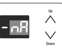
Da biste onemogućili prikaz upozorenja **nA** i alarm, pritisnite gumb **ALARM**. Alarm će se odmah isključiti i prikazat će se najviša zabilježena temperatura tijekom nestanka struje. Ta će se temperatura prikazati za otprilike 1 minutu. Da biste odmah poništili prikaz najviše temperature, ponovno pritisnite gumb **ALARM** i na zaslonu će se prikazati stvarna temperatura u uređaju.
