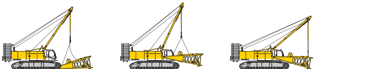
Entladung und Anbau des Auslegeranlenkstückes
