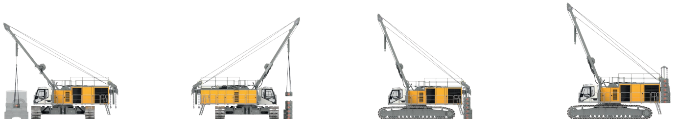
Entladung, Zusammen- und Anbau des Heckballastes
