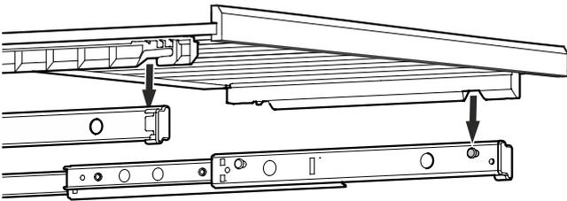
Auzugschienen ganz herausziehen. Das Holzbord mit den vorderen Ausnehmungen auf die Haltebolzen aufsetzen.
