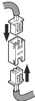
29. Steckerverbindung in die Halterung einrasten.
