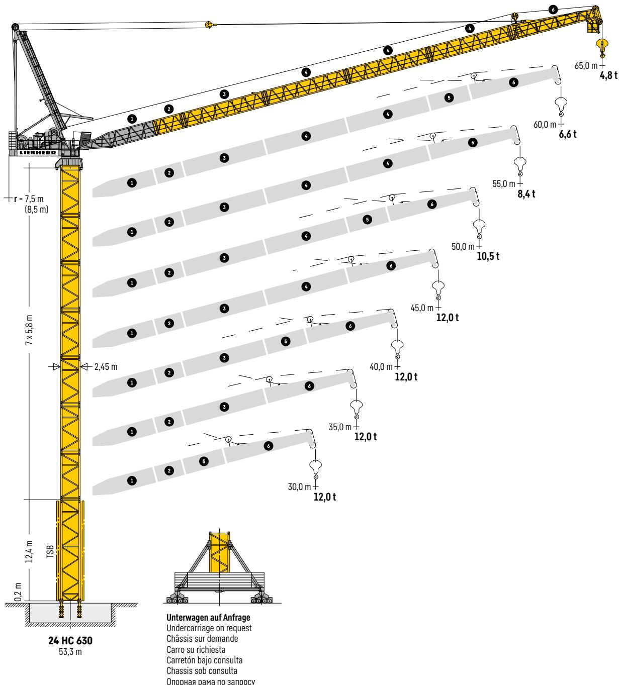
**Tragfähigkeiten gültig bis 100 m Hubhöhe. Über 100 m Hubhöhe reduziert sich die Tragfähigkeit um das zusätzliche Seilgewicht.** • Lifting capacities valid up to 100 m hoisting height.
