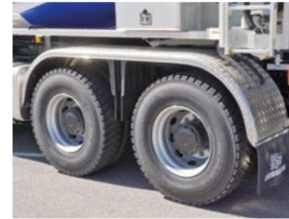
Hinterradkotflügel aus Aluminium
