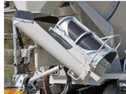
Leichtbau-Klappschurre mit Schutzbügel
