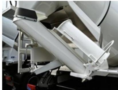
Stahl-Klappschurre mit Schutzbügel
