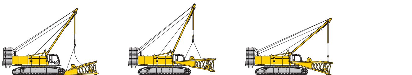
Déchargement et montage du pied de flèche
