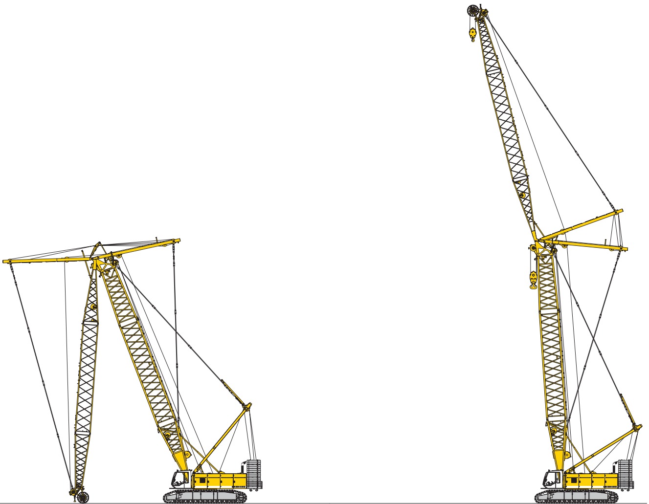
Relevage de la flèche principale et de la volée
