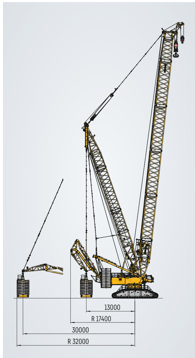
V-Frame® offre une flexibilité maximale grâce à ses rayons de contrepoids réglables en continu.
