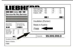
Дата изготовления оборудования наносится в левом нижнем углу заводской таблички. Дата изготовления маркируется в формате "ГНН", где "Г" — последняя цифра года изготовления, "НН" — номер календарной недели изготовления.
