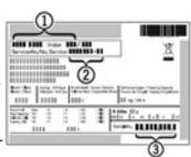
номер (2) и номер прибора (3), указанные на табличке с техническими характеристиками. Расположение таблички с техническими данными показано в разделе «Описание прибора».
